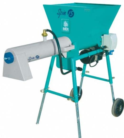
Mezclador continuo, ideal para mezclar rápidamente y de una manera homogénea diferentes materiales premezclados, como mortero gris y mortero monocapa, para una vez mezclados con la cantidad de agua correspondiente, ser vertidos sobre un recipiente (carro chino, pastera, etc.), o también sobre una máquina que los bombee y proyecte.
